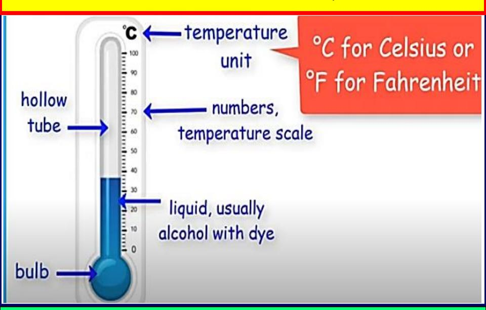
তাপমাত্রা পরিমাপক যন্ত্র (Thermometer)
